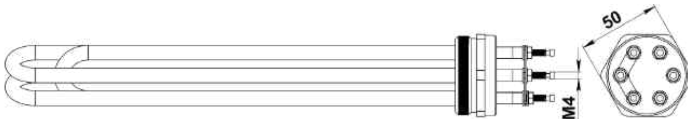
Рис. 3 Блок трубчатых электронагревателей (ТЭНб)
