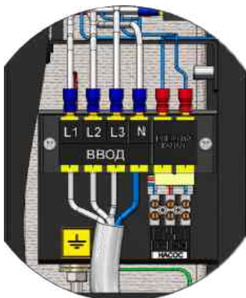
Рис. 7 Схема подключения электроводонагревателя к трехфазной сети 380 В
